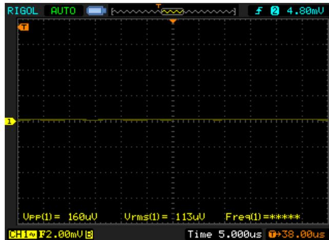
Cette mesure représente l'incertitude des mesures :  $160\mu V_{pp}$  –  $113\mu V_{rms}$
