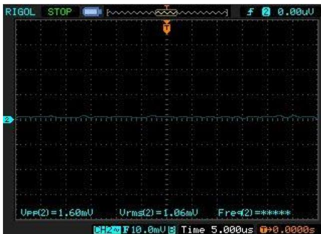
Compte tenu du seuil de bruit plus élevé sur la sonde 2, le filtrage par Li,Ci a là aussi rendu le bruit dû au « rejected current » du convertisseur insignifiant.
